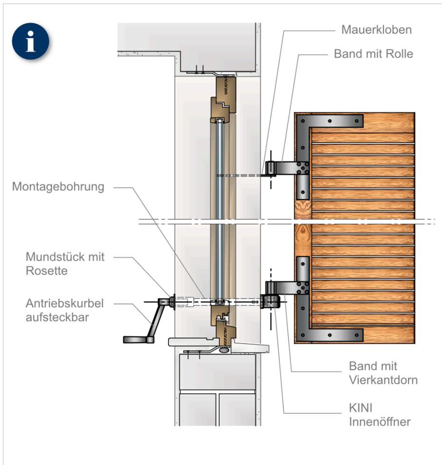
Die KINI-Innenöffner ersetzen bei Fensterläden den untern, bei hohen Türklappläden den mittleren Achspunkt. Anstelle der standardmäßig verwendeten Mauerkloben wird der Innenöffner mit einer Montagebohrung seitlich der Laibung durch die Wand geführt.
